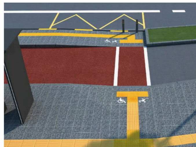
站台适老化设计示意图
