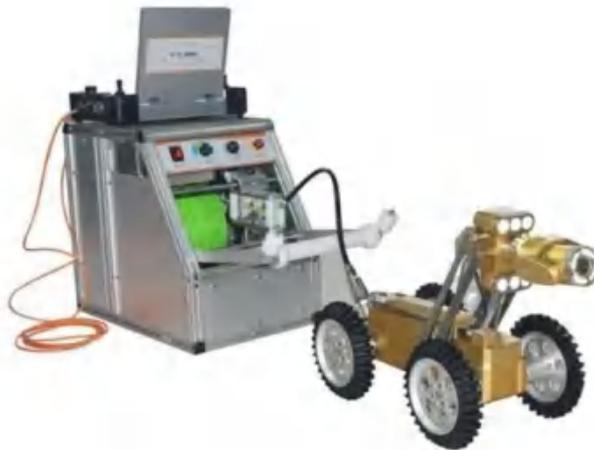
CCTV 管道检测机器人
