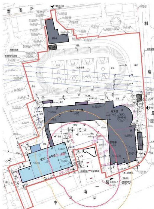
图 3-1 拟拆除建筑总体布局图
