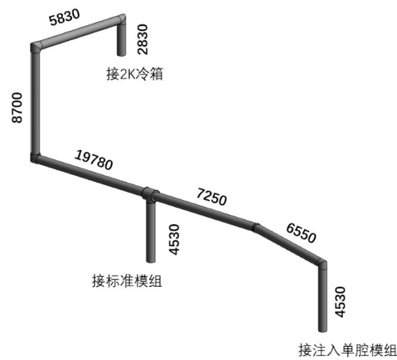
图2 六通道传输线（2K冷箱-模组）
