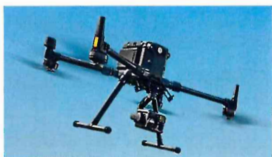
多旋翼无人机搭载红外热像设备
