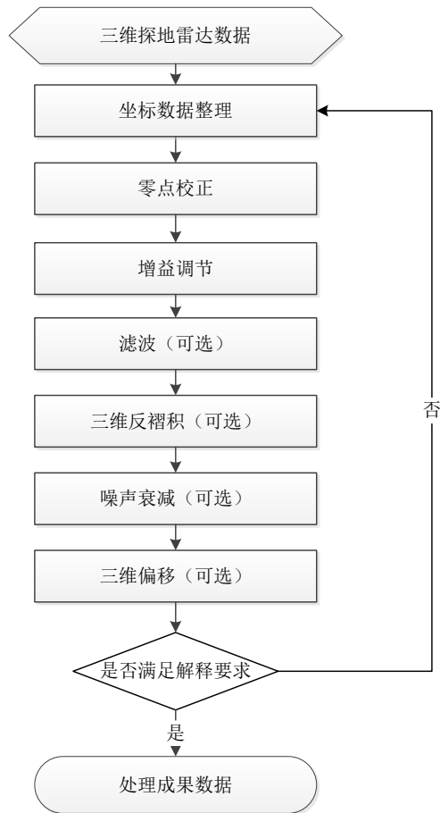
图 3.6.1 三维探地雷达数据处理流程图
